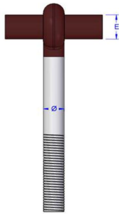
Figur 18: Fjellbolt som brukes for å feste forankringslinjer i fjell [23]
