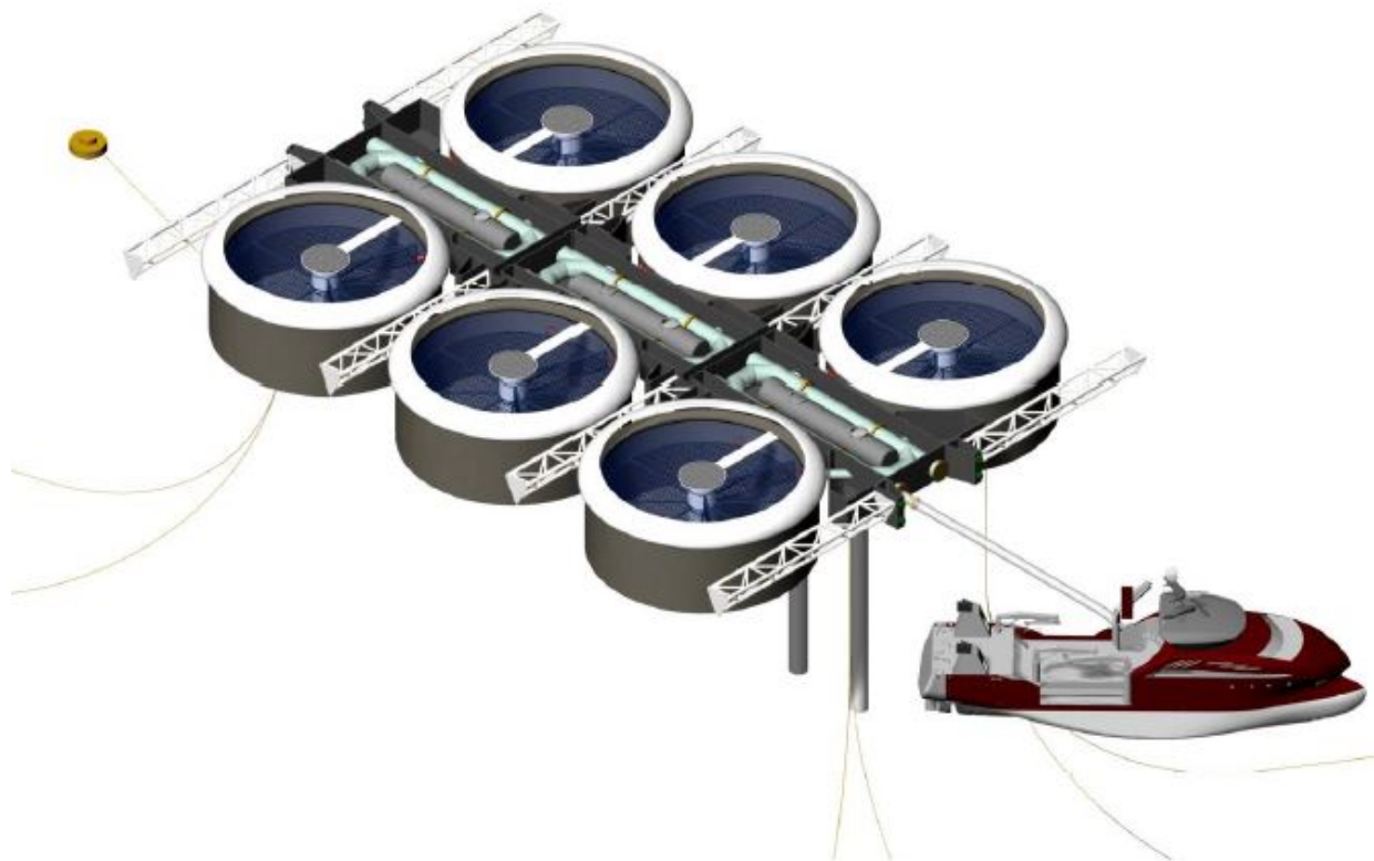
Figur 2: Figuren viser hele OceanTECH-konseptet med merder som er fortøyd til prosessanlegget
