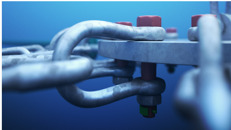
Figur 20: Figuren viser bruk av sjakkel for å koble sammen kjetting og koblingsplate [26]
