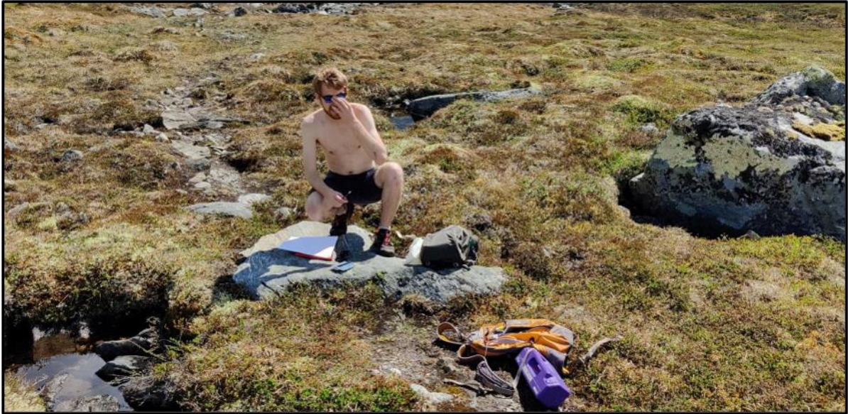
Figur 5.2: Bilete av lokalitet 1 med blokka det er avlese schmidthammar målingar på i sti som er der person sit, samt den forvittra blokka som er avlese schmidthammar verdiar på til høgre i biletet. Bakom blokka det er avlese schmidthammar målingar på er det teke lausmassemålingar.
