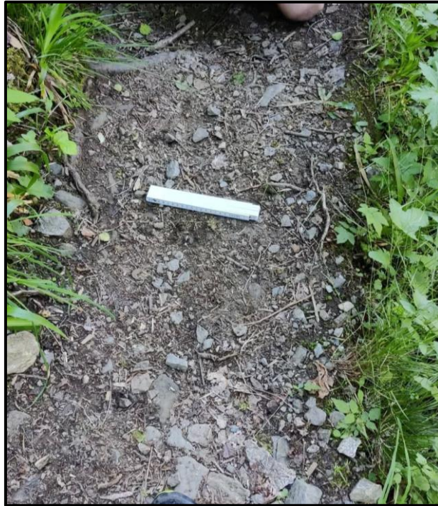
Figur 5.28: Lokalitet 1 ved første feltundersøking der ein kan sjå det er dominert av grusstørrelsar som er antropogene avsetningar, målestokken er om lag 21 cm. Fotograf: Sindre Befring Hage.
