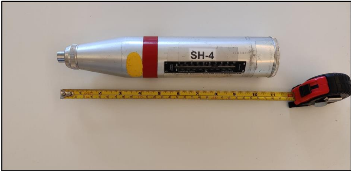
Figur 4.1: Bilete av ein av dei to schmidthammarane av typen N som er nytta under feltundersøkingane i Geiranger verdsarvområde. Målebandet er om lag 31 cm. Fotografi: Sindre Befring Hage.
