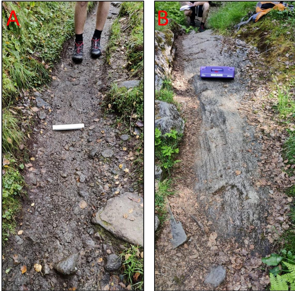
Figur 5.37: A: Lausmassane det er avlese djupne- og breidde-målingar frå. Meterstokk om lag 21 cm. B: Blotningen det er avlese schmidthamarverdiar frå. Schmidthamar-boks om lag 30 cm brei. Fotograf: Sindre Befring Hage.
