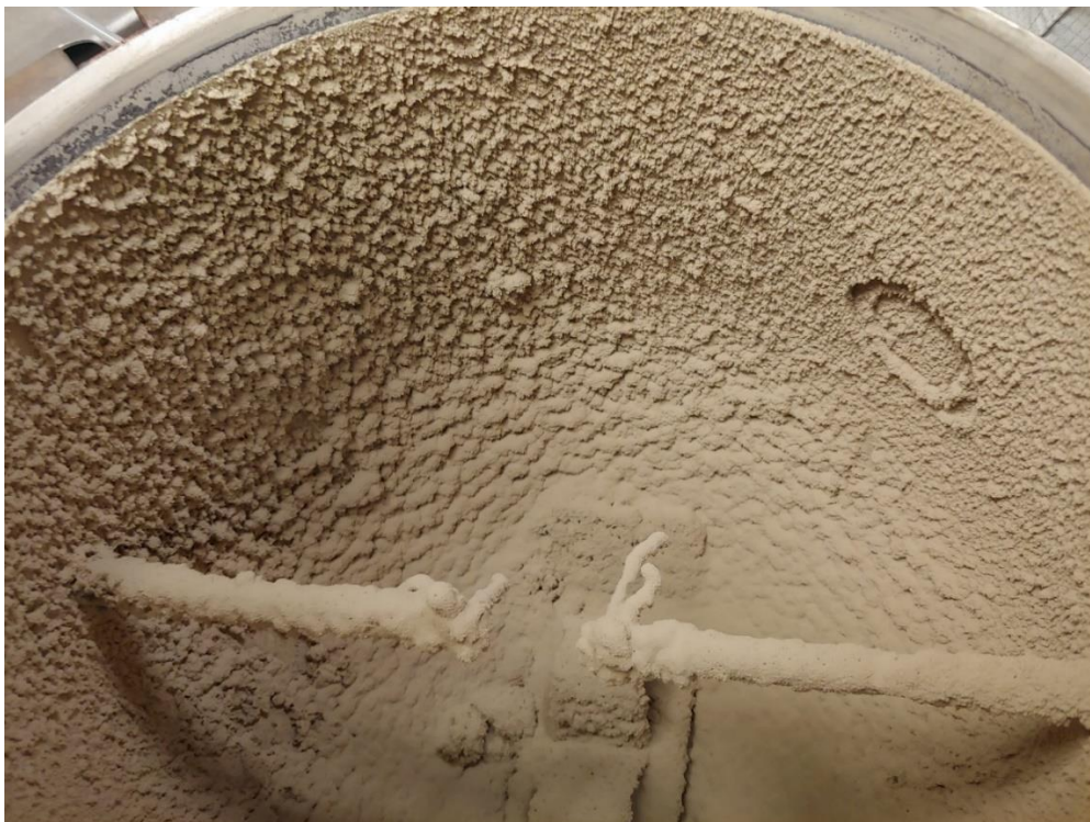
Figur 4-12 Blanding H40_B60 med konsentrasjon c = 1250 \text{ g m}^{-3} , serie 1 med P_m = 7,8 \text{ barg} og (dP/dt)_m = 648 \text{ bar s}^{-1} . I tillegg til å se de karakteristiske nuppene langs veggene og bølger nede, kan man se tennerne er blåst vekk.
