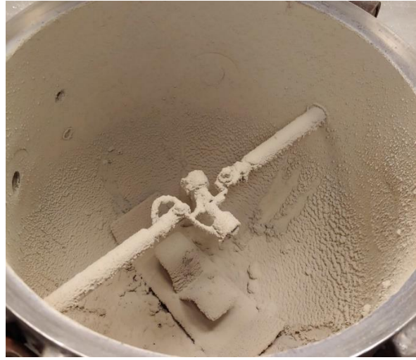
Figur 4-11 Referansekjøvet B100 ved c = 750 \text{ g m}^{-3} har gitt det brune kondensatet. Typisk mønster med nupper er dannet langs veggene og bølgeformet mønster i bunnen av kammeret etter at silisiumoksidgass har kondensert.
