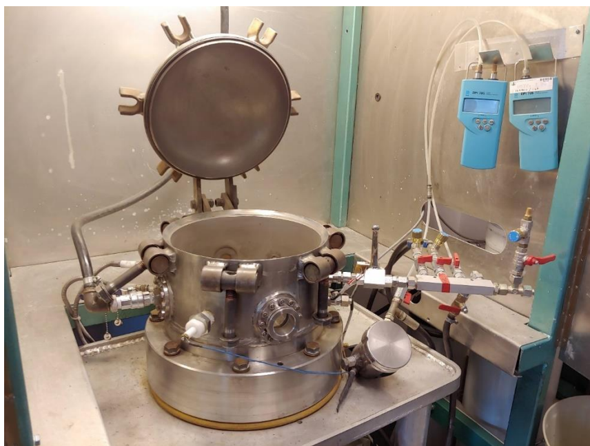
Figur 3-1 Bildet av oppsettet. Fra venstre til høyre: avtrekksslange opp til ventilasjon; eksosventil; 20-liter kammer med lokk; ventil til juletre; juletre; festet til juletre er ventil nedover til vakuumpumpe, til høyre nåleventil, to ventiler for tilkobling av gass og ventil til trykksensor på veggen. Nedenfor juletreet er reservoaret som er tilkoblet trykksensor på veggen. Ikke på bildet er måle- og styreenheten, vakuumpumpen og trykkluftflasken.
