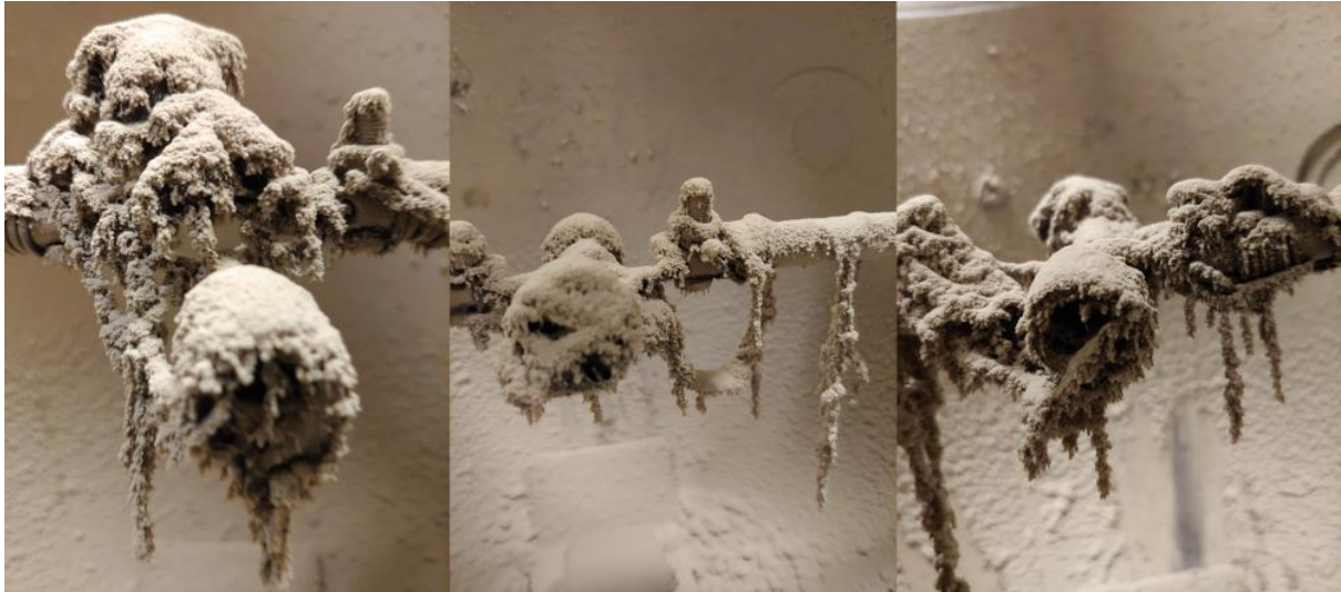
Figur 4-13 Remser av silisiumoksid som henger ned fra tennerne. De er svært lette og blafrer ved den minste bevegelse av luft. Konsentrasjon for alle disse er c = 750 \text{ g m}^{-3} , men remsene kunne oppstå ved c = 500 \text{ g m}^{-3} . Venstre og midten er blandingen H40_B60 og høyre er H20_B80.
