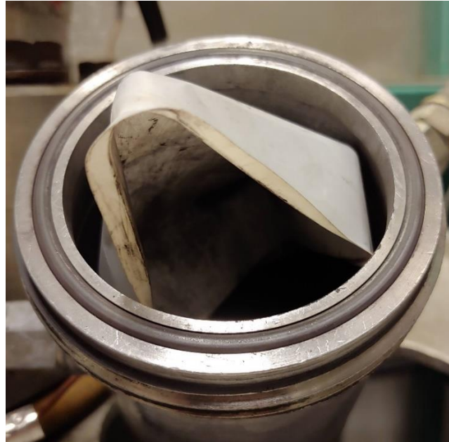
Figur 3-5 Støvet blir deponert i reservoaret ved å bøye begeret slik at det får plass inne i reservoaret og deretter vippe det rundt som vist over. Slik minskes sannsynligheten for søl.
