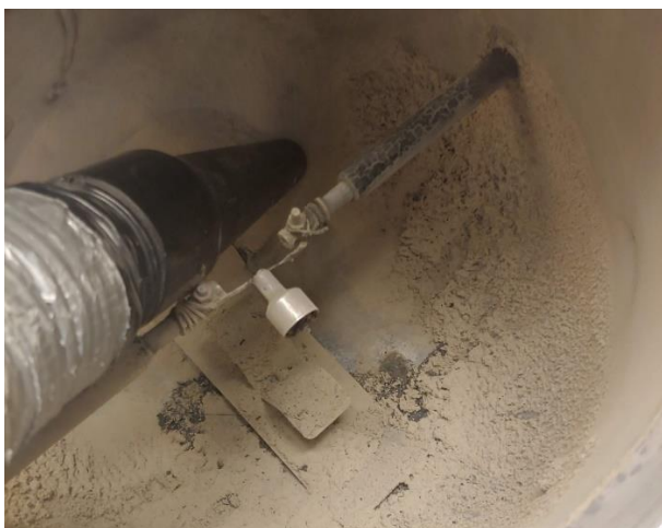
Figur 3-6 Rengjøring av kammeret med industriell støvsuger. Under det brune silisiumoksidet kan man se uforbrent silisium.
