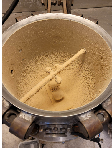
Figur 4.13: viser et bilde av produktene fra en test ved 750 \text{ g/m}^3 per kubikk og en tydelig oransje farge. Dette skjedde noen få ganger ved konsentrasjoner på 750 \text{ g/m}^3 og 1000 \text{ g/m}^3 , men det var ikke reproduserbart.
