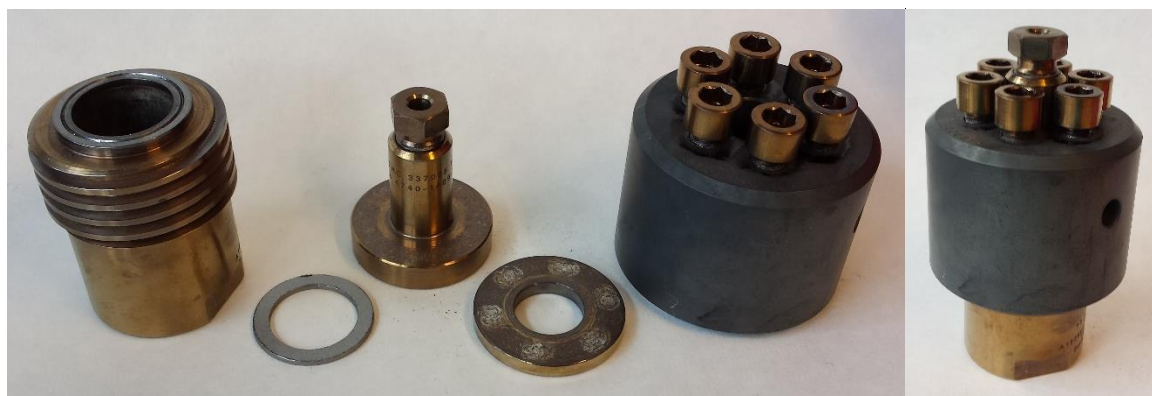
Figur 4.2: Den åpne reaktoren til venstre består av en bunn med en myk grafitt pakning, en overdel med ventileringshull, en metallskive og et topplokk. Den lukkede reaktoren er nøye montert sammen etter en bestemt prosedyre.
