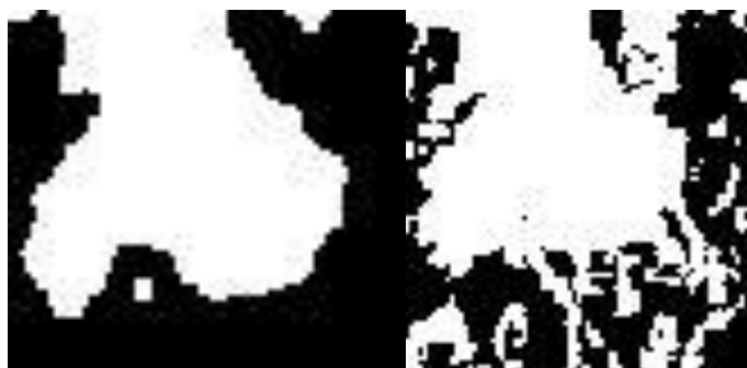
Figur 40. Leibottskåka etter og før bruk av median filter Kernel 3x3. venstre: Støy fjernet med Kernel 3x3 median filter. Høyre: Støy ikke fjernet etter klassifisering
