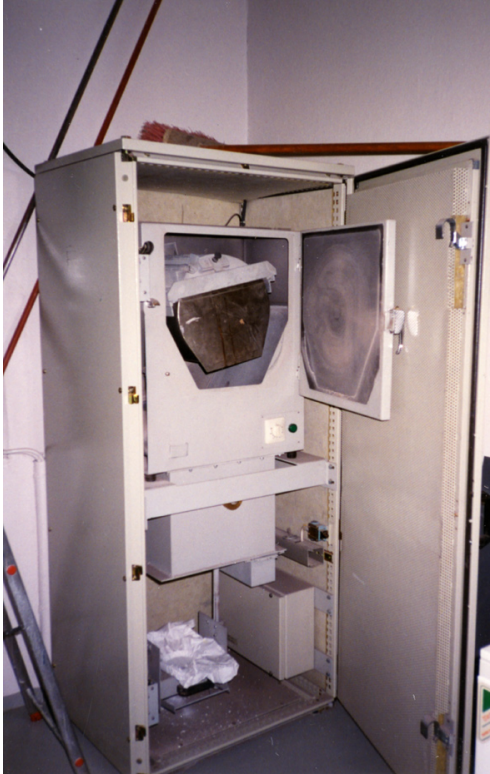
Figur 5. Askebereder hvor beinene blir malt opp etter kremasjonen før asken blir lagt i urne. Foto: Terje Østigård.
