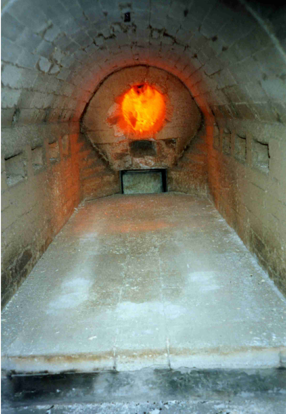
Figur 2. Kremasjonsovn for insettelse av kiste. Foto: Jonny Ottesen.
