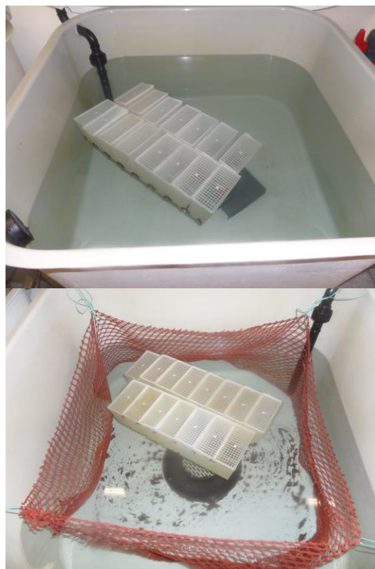
Figur 6: oppsett av forsøk utført i uke 6 og 7. Nederste bilde viser oppheng av kobberimpregnert not.
