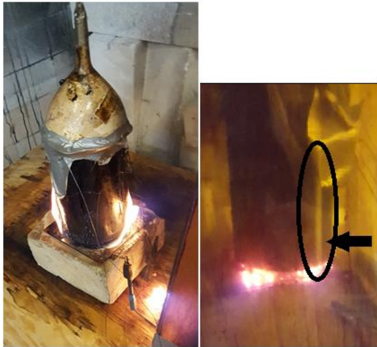
Figur 46: Antennelse av oksiderbar røykgass utviklet seg til flammebrann i bomullsforsøk 3. Bilde t.h. illustrerer røykstrålen.
