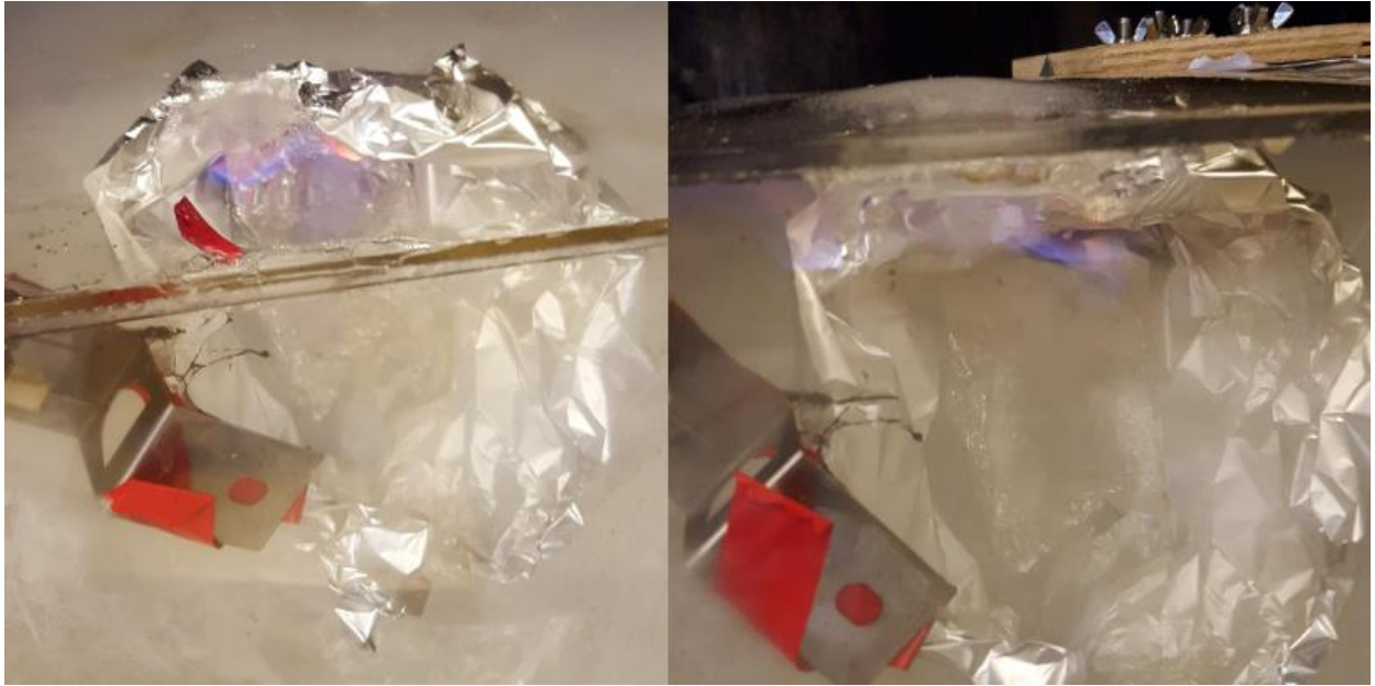
Figur 33: Antenning av røykgass.
