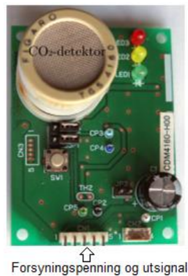
Figur 19: CO 2 detektor av type CDM4160-H00. Pinn 1 – 5 er plassert nederst på figuren fra venstre til høyre [37].
