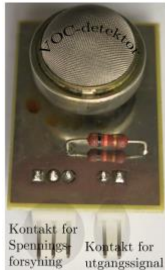
Figur 24: VOC sensor montert på en trykt strømkrets med R_l og kontakter for V_h , V_l og utgangssignalet V_{voc\ ut} [37].
