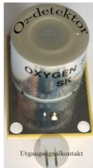
Figur 22: Oksygen sensor montert på en trykt strømkrets [37].
