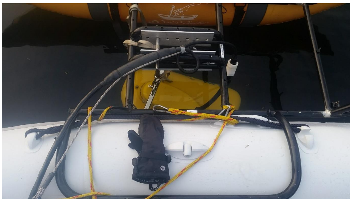
Figur 3.2: Bildet viser chirpen (gul) som ble brukt til å samle inn seismikk fra Gunnarstadvatnet. Under feltet ble chirpen montert fast på siden av en gummibåt og er her klar for bruk. Chirpen var koblet opp til en bærbar PC, slik at det var mulig å studere seismikken direkte i feltet.
