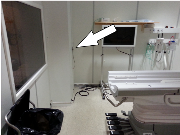
(a) Antennen henger like innenfor Faradayburet på en skapdør
