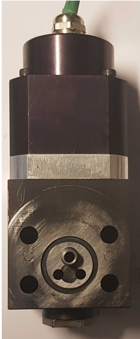
Figur 52: Magnetventilen som ble brukt i testen.
