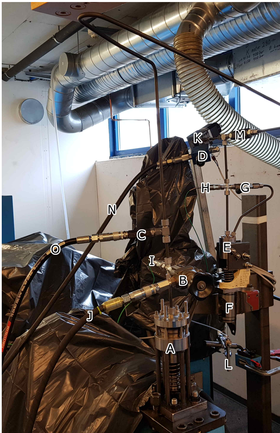
Figur 14: Bilde av testoppsettet. A - Pumpe, B - Sikkerhetsventil, C - Tilbakeslagsventil, D - Trykkeldeventil, E - Aktuator, F - Motorventil, G - Tilbakeslagsventil med struping, H - Trykkmåler, I - Trykkmåler, J - Returslange til matepumpens tank, K - Magnetventil, L - Lengdegiver, M - Tilbakeslagsventil, N - Returslange til matepumpens tank, O - Tilførselsslange fra matepumpen.
