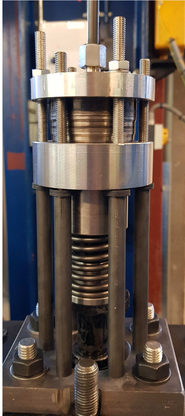
Figur 18: Pumpen satt sammen og montert på testbenken.
