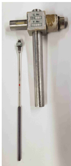
Figur 26: Posisjonsgiveren som ble brukt for å måle posisjonen til spindelen i motorventilen.
