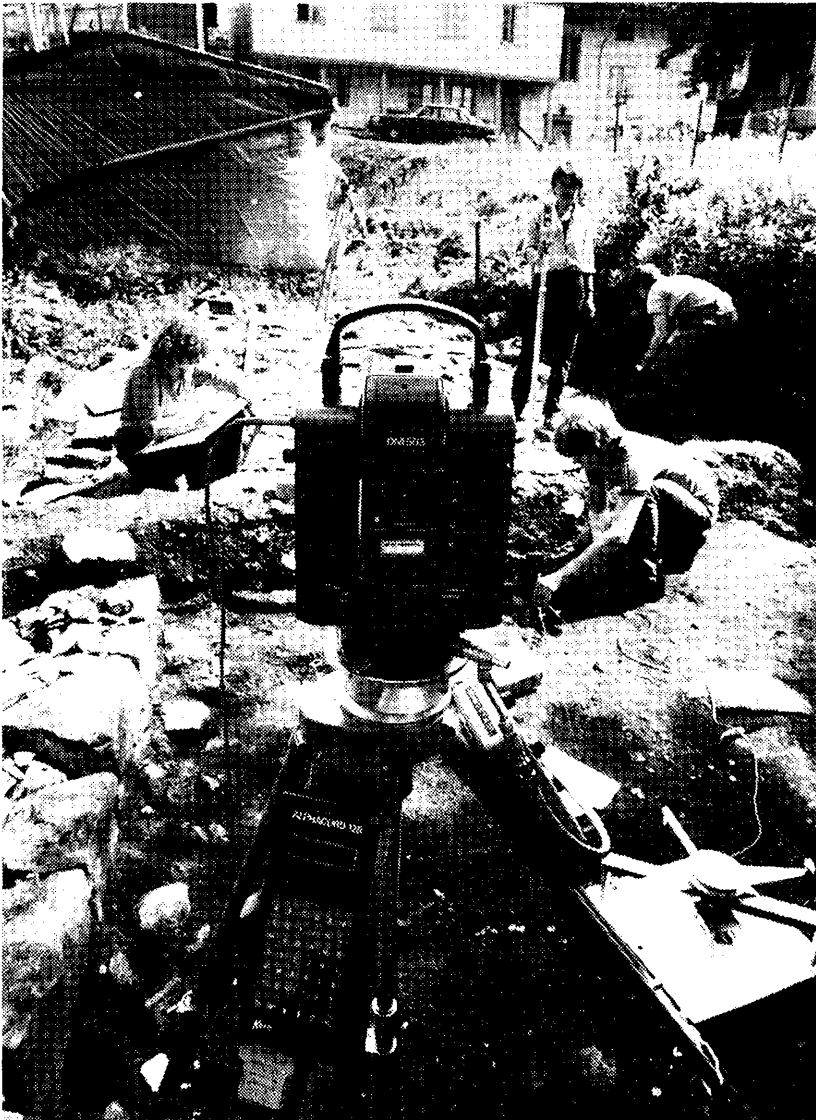
Gamle og moderne måle- og tegneinstrumenter side om side. Til venstre på bildet: manuell måling og tegning. I forgrunnen til høyre innmåling ved hjelp av en tegne maskin (pantograf). I forgrunnen midt på bildet et edb-basert landmålingsinstrument som via en reflektor på målestedet (på stangen i bakgrunnen) gir X-, Y- og Z-koordinater ved å trykke på en knapp. Bygningen i bakgrunnen er Oslo Ladegård. Foto: Knut Snare, Aftenposten.
