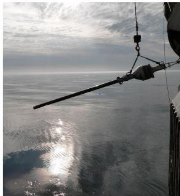
Figur 4.1 En gravity core tatt under cruiset og lastet ombord i skipet i tilnærmet horisontal posisjon. Foto hentet fra Jansen 2015.
