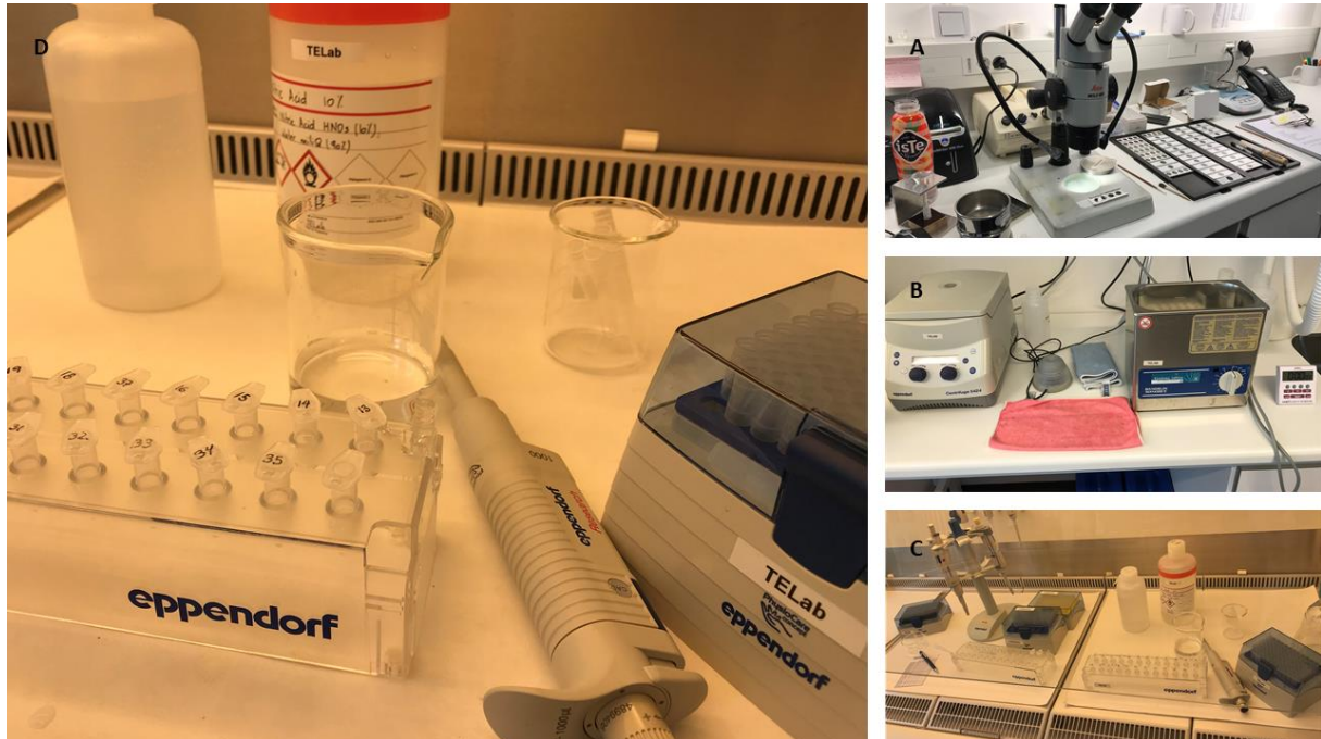
Figur 4.5: Figuren viser ulike faser i laboratoriearbeidet. A: Plukking av M. barleeaanum før Mg/Ca analyse og isotopanalyse. B: Sentrifuge til venstre og ultralydbad til høyre i bildet. C: Arbeidet med rensingen ble utført under en ventilatorhette for å sikre rene arbeidsforhold. D: Brett med mikrotuber og pipette for nøyaktig mengdemålinger. Foto: S. T. Bårdsnes.
