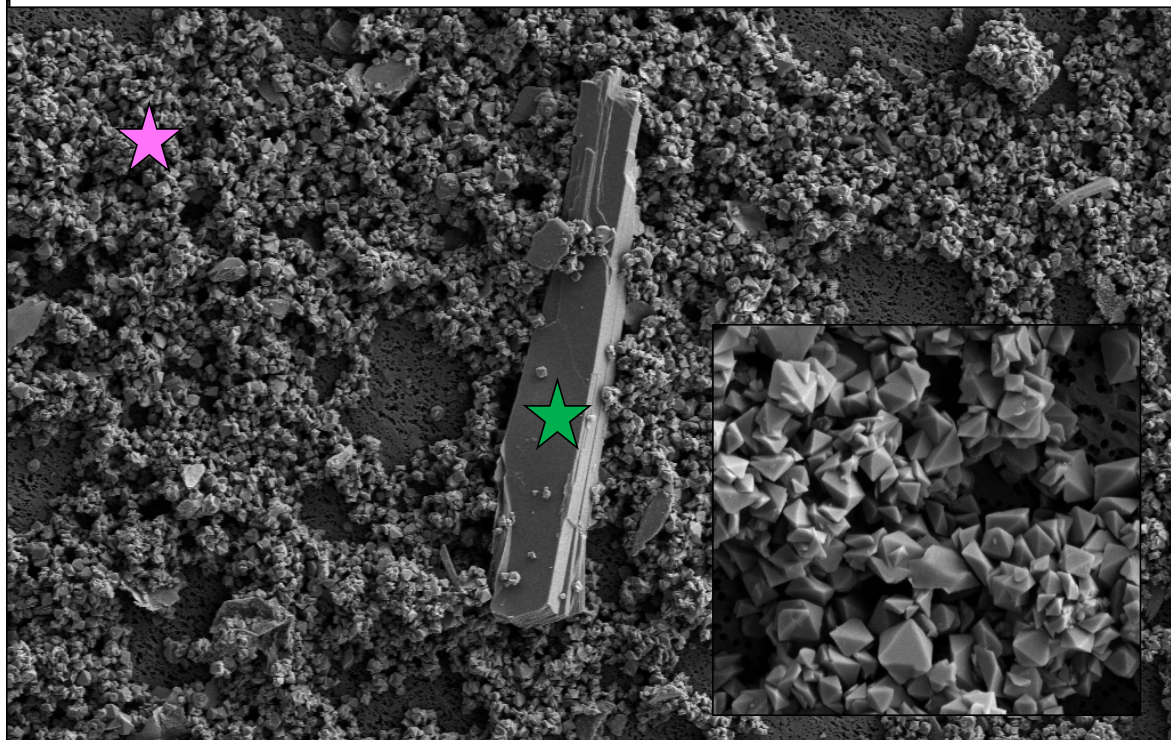
Figur 5.4.3. Mikrografier av mineralprøve hentet i Grønligrotta (GR18_1). Prøven bestod hovedsakelig av to ulike krystallformer. Den ene typen hadde kubisk krystallform (rosa stjerne) og passer med jarositt, mens den andre hadde flakete krystallform (grønn stjerne) og passer med andre observasjoner av gips. Det ble også observert noe som kan se ut som en kort, stavformet celle (indikert ved hvit pil).
