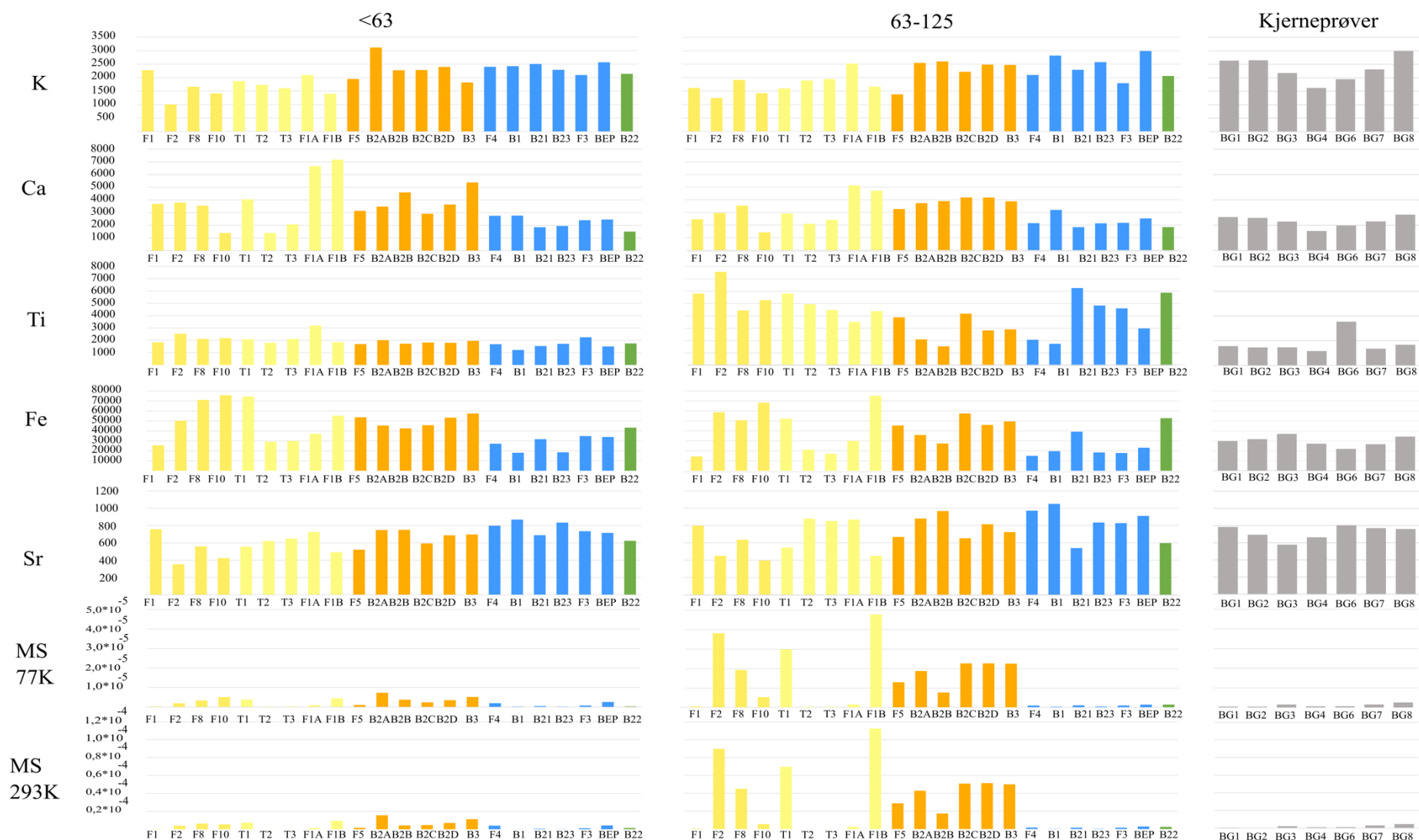
Figur 4.26 – Plot av jordartsprøver og sedimentkjerneprøver mot XRF-parametere og miljømagnetisme. Prøvenavn er merket under søylene for hver parameter. Jordartsprøvene er gitt farger etter NGUs klassifisering av løsmasser (NGU, 2020b). For fluviale prøver er to ulike gulfarger valgt for å skille prøvene tatt ved terskelen og fra det fluviale deltaet ved Flakksvann. Jordartsprøvene er delt opp etter kornstørrelser. Sedimentkjerneprøvene er plottet i grått, til høyre for jordartsprøvene og er ikke siktet etter kornstørrelse.
