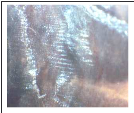
Figur 16. Etter polering viste trådklammerprotesen omtrent samme grad av overflateruhet som før polering.
