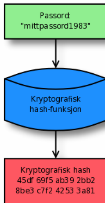
Figur 9.3: Eksempel på hvordan "signaturen" til et passord kan genereres
