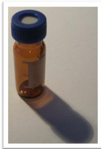
Figur 7: Prøveglass 32x22,6 mm à 2 ml
