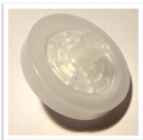
Figur 6: Steril sprøytefilter fra Life Sciences® Porestørrelse på 0,22 \mu\text{m} , Nylonmembran.
