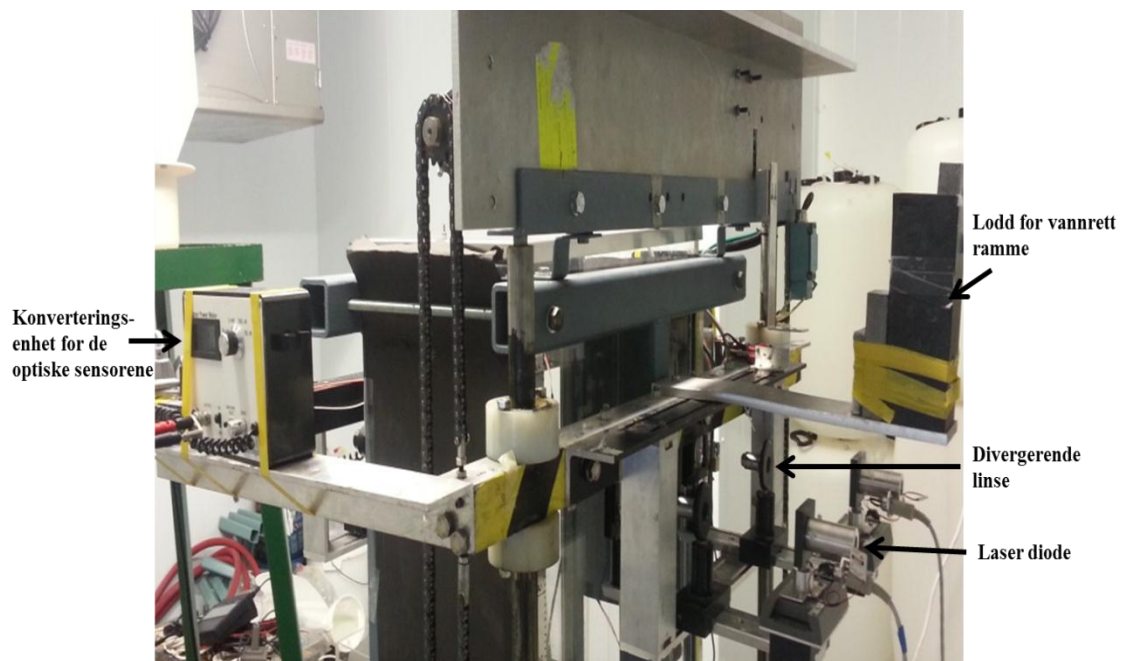
Figur 6: Det eksperimentelle oppsettet av vannkolonnen, del 1
