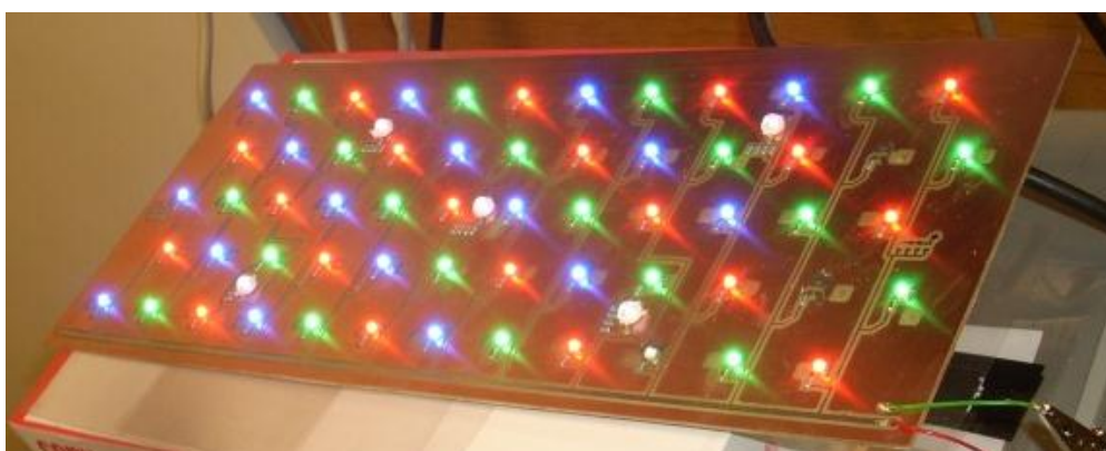
Figur 12: Det ferdige LED-panelet; et kretskort med påmonterte LED-pærer og med tilpassede motstandsverdier for hver farge.
