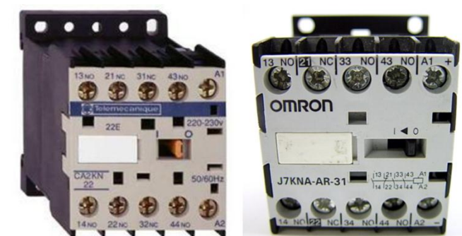
Figur 8: De to industrielle reléene som brukes i dette systemet. Tallene representerer kanaler og bokstavene ved siden beskriver kanalenes normale posisjon. A-kanalen er strømforsyning.
