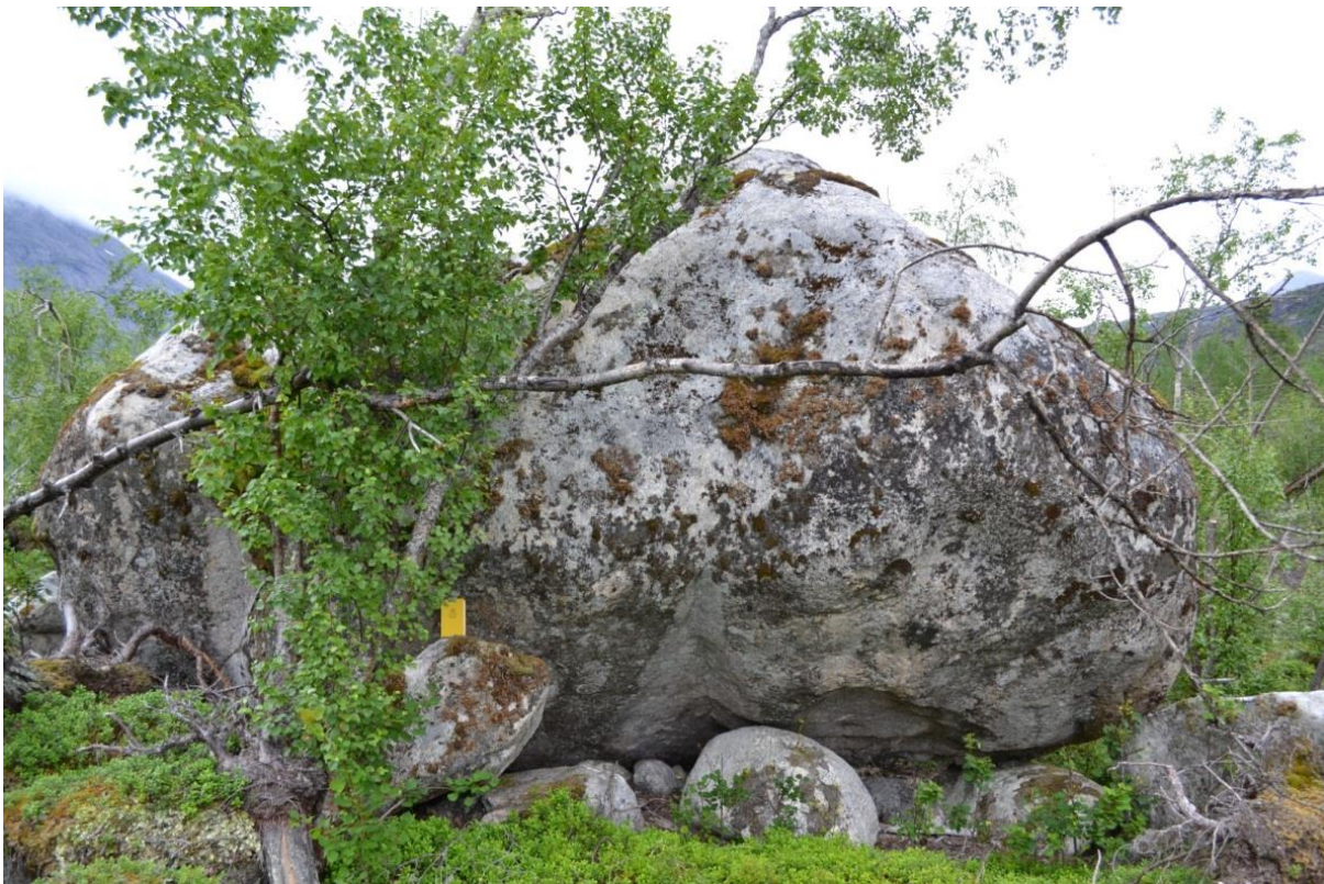
Figur 5.1: En av de oppmålte blokkene på Stuorlænndo i Hellmobotn distalt for munningen av Hellmogjelet. Målene på blokkene er benyttet for å gi et estimat på vannføringen. Notatblokk som målestokk
