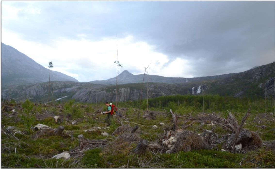
Figur 4.6: Georadarundersøkelse utført sommeren 2011. Grovt materiale og store mengder røtter og kvist vanskeliggjorde arbeidet og påvirket resultatet.
