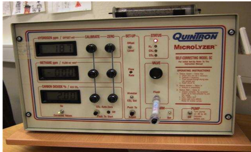
Figur 2.2 Bildet viser Quintron Microlyzer. Oppsamlet gass sprøytes inn i kolonnen via tørkemiddelet. Gassekskresjon avleses i vinduet øverst til venstre. Foto: privat.
