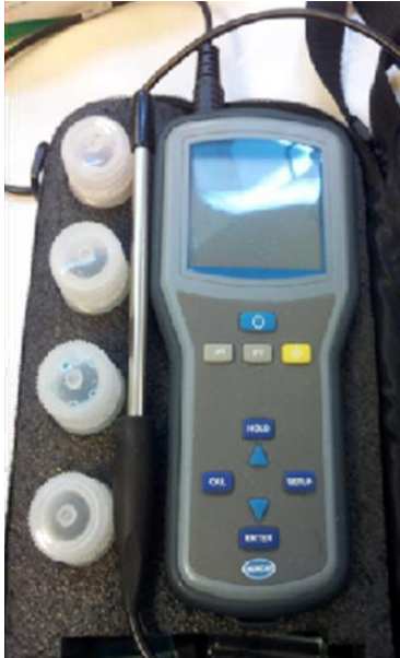
Figur 2.2.4.1: Bærbart Hack Lange pH-meter fra Nerliens Meszansky AS.
