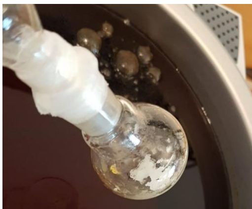
Figur F.2: Prøven etter et døgn på oljebad viser hard konsistens.
