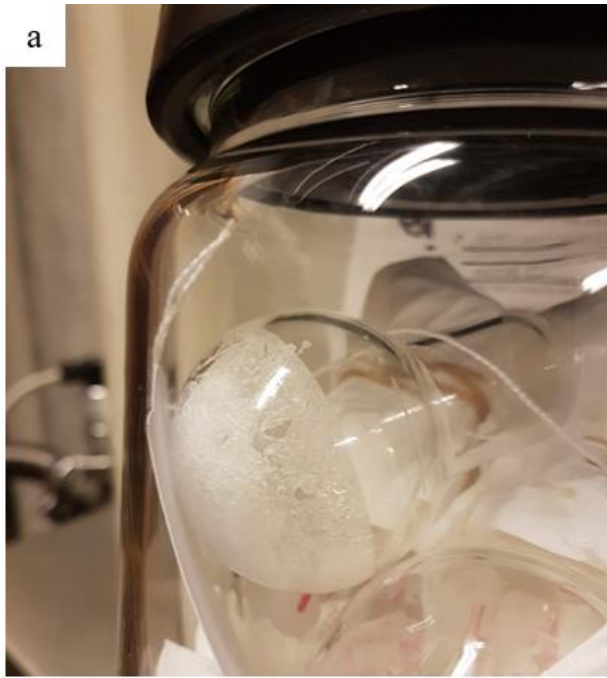
Figur 5.1.3a: Prøven vist etter et døgn med frysetørring. Den har et hvitt utseende. b: Bilde viser suspensjonen av prøven overført til plastrør.
