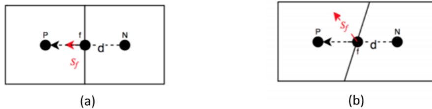
Figur 17: Ortogonale (a) og ikke-ortogonale celler (b) [28].
