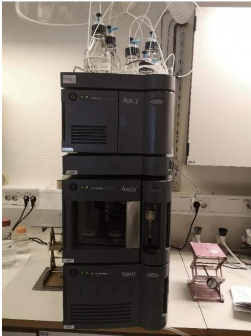
Figur 7 UPLC-systemet som bestod av Waters Acquity TUV detektor, Waters Acquity Sample manager, Waters Acquity Binary solvent manager, kolonne (Waters Acquity UPLC BEH C18 1.7 \mu M, art. nr. 186002350) og integreringssystemet, Empower 3 (TBE and Havforskningsinstituttet, 2019b). Foto tatt fra laboratoriet.
