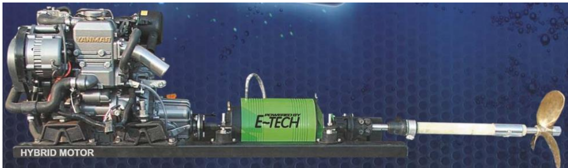
Figur 8: E-Tech parallellhybrid for fritidsbåter [17]
