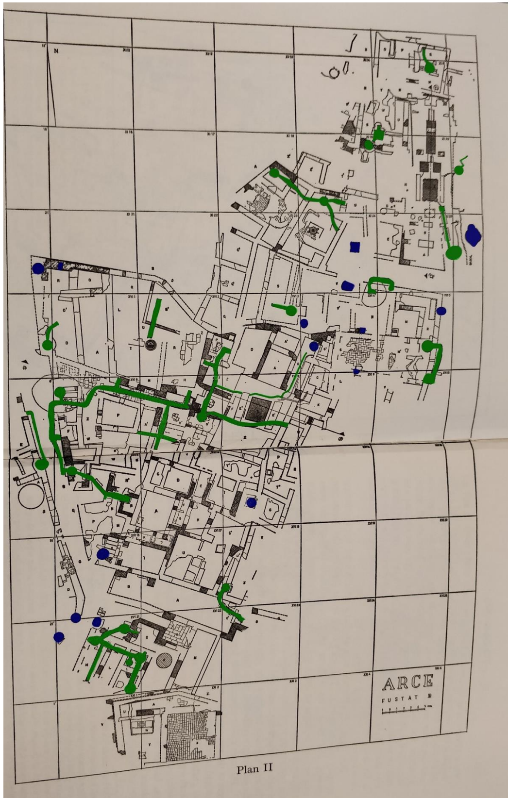
Figur 33: Kart over kloakk- og vannsystem under Fustat. Kloakkkanaler og avfallsgroper i grønt, vaskevannsgroper i mørkeblått. Hentet fra Hourani, A. H. og Stern, S. M. "The Islamic City," s. 190-191
