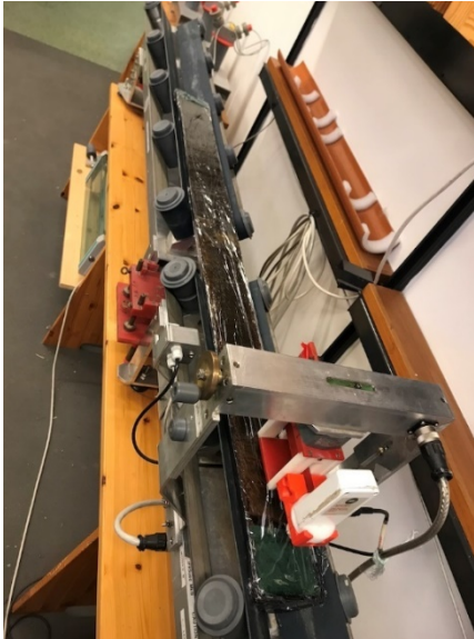
Figur 4.5. CoreSusc MK III Corelogger, EARTHLAB, UiB. Eit punkt vart målt per 0.2 cm kjernedjupn.
