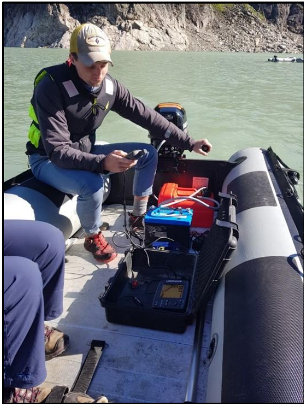
Figur 4.1: Batymetrisk kartlegging av Mysevatnet med ekkolodd av typen «Lowrance Elite 5HDI». Foto: Marte Eimind Kvalnes
