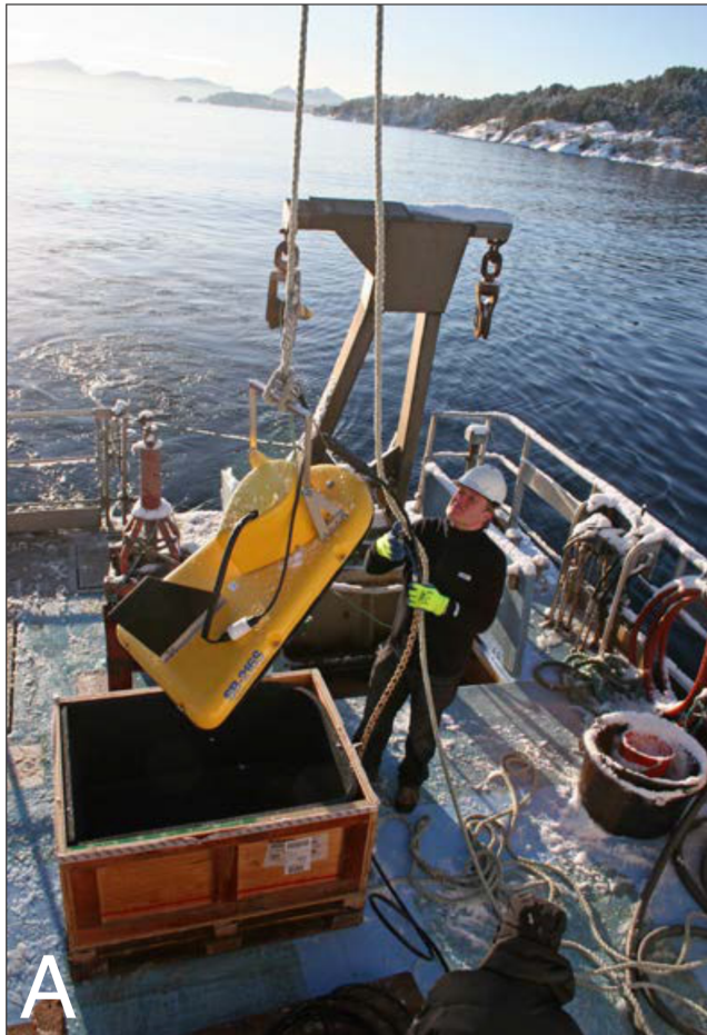
Figur 3.3: A: Mobilt EdgeTech 3100 chirp penetrasjonsekkolodd. Foto: Eva Bjørseth. B: Fallkjerneprovetaker. Foto: Heidrun Myrvold Sande
