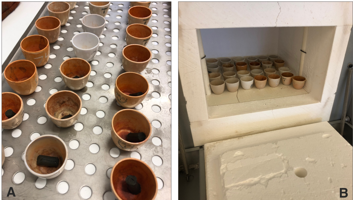
Figur 3.4: Bilder fra glødetapsanalyse. A: Digerer med våtprøver tatt fra kjernene før de blir tørket i tørkeskapet. B: Digerer med prøver som er satt inn i ovnen og klare for å bli brent på 550°C og 950°C. Foto: Heidrun Myrvold Sande.
