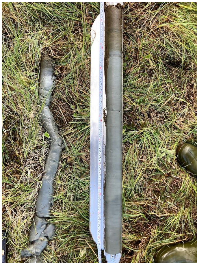
Figur 2.2, Bilde av en Russerbør fylt med sedimenter, til venstre kan man se en tidligere sediment prøve som ble forkastet, en stor fordel med dette systemet er at man kan se sedimentene før man pakker dem inn og deretter ta vurdering i felt om behov for justeringer i prøvetakingen.
