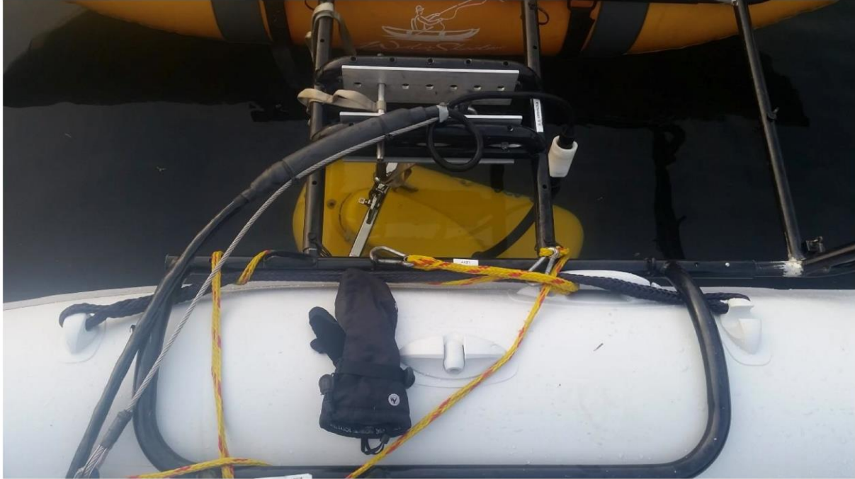
Figur 3.2: I Søre Kobbervatnet ble det brukt chirp (gul) for å samle inn seismikk. Dette ble gjort av Johnsen (2017) og Hernar (2017) under deres feltarbeid. Bildet er hentet fra Johnsen, 2017.
