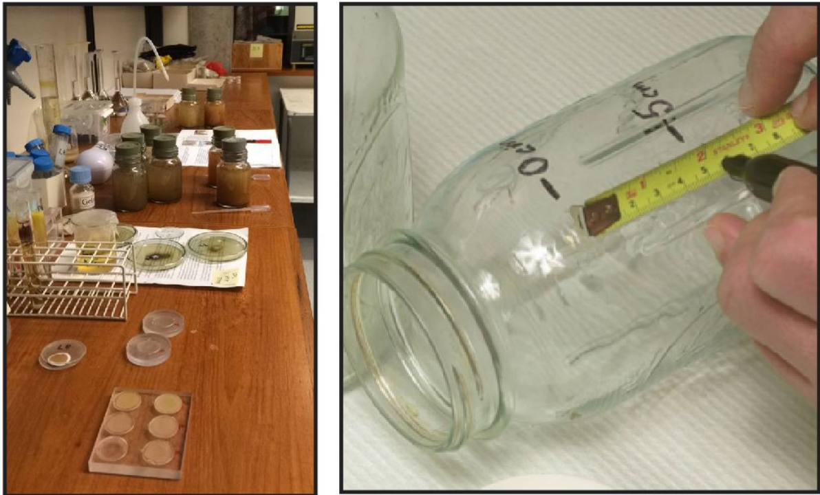
Figur 3.7 Viser markeringen av 0- og 5 cm merkene på glassene. Bildet til høyre er fra prosedyren til U. S. Department of the interior .
