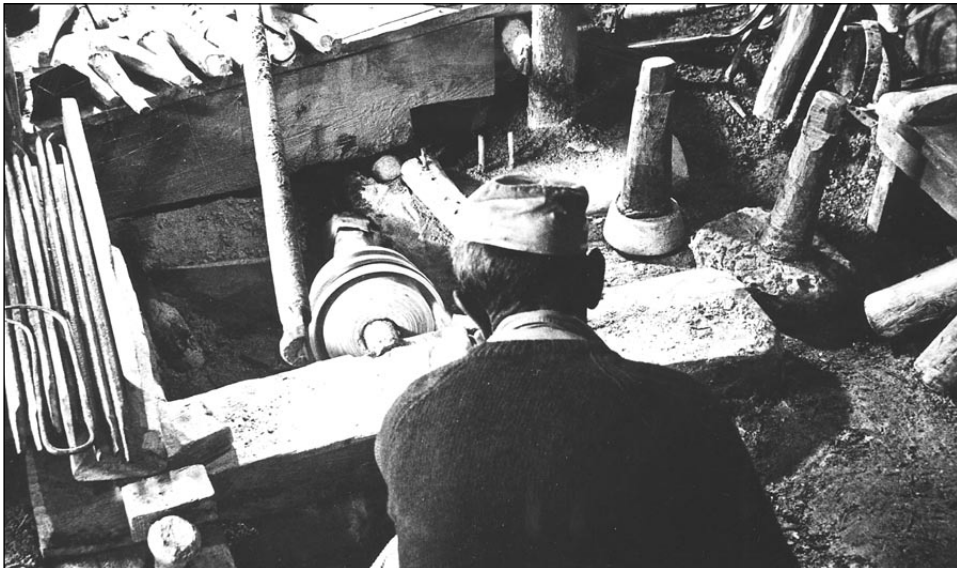
Figure 2. The artisan is working on a water-powered turning lathe. © Schweizerische Gesellschaft für Volkskunde, Basel.
