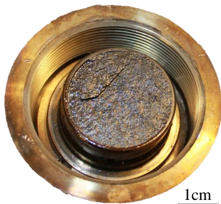
Figur 3-2 Den ferske bruddoverflaten til KJ-2 mettet med fluid reflekterer et spekter av ulike farger som er typiske for olje.
