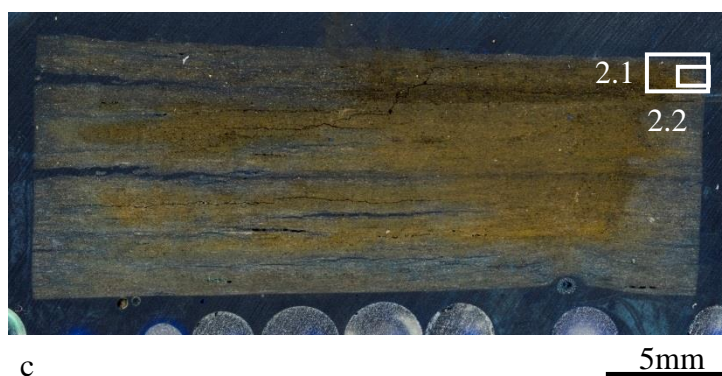
Figur 3-5 Umodnet kjernesnitt (a), eksperiment 1 (b) og 2 (c) med oversikt over hvor fluorescensbildene ble tatt. Eksperiment 1 og 2 ble utført med tilsatt vann. Prøvene er satt i epoksy og langs bunnen på bildene vises et lag av glassperler. På det umodnede kjernesnittet er inndelingen av de øvre og nedre kjerneprøvene vist. Med unntak av umodnet kjernesnitt er det stor oppsprekking gjennom hele snittet med utarming av hydrokarboner langs sprekker og kanter. Kjerneprøven fra eksperiment 1 har isolerte luftlommer som ikke er fylt med epoksy
