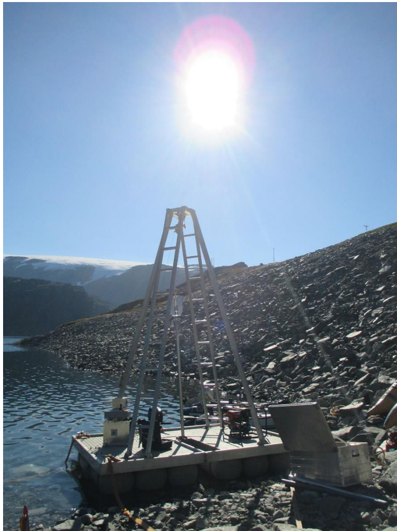
Figur 7 Bilete syner flåta nytta under prøvetaking med fallprøvetakar. Foto: Eva Maria Lunnan
