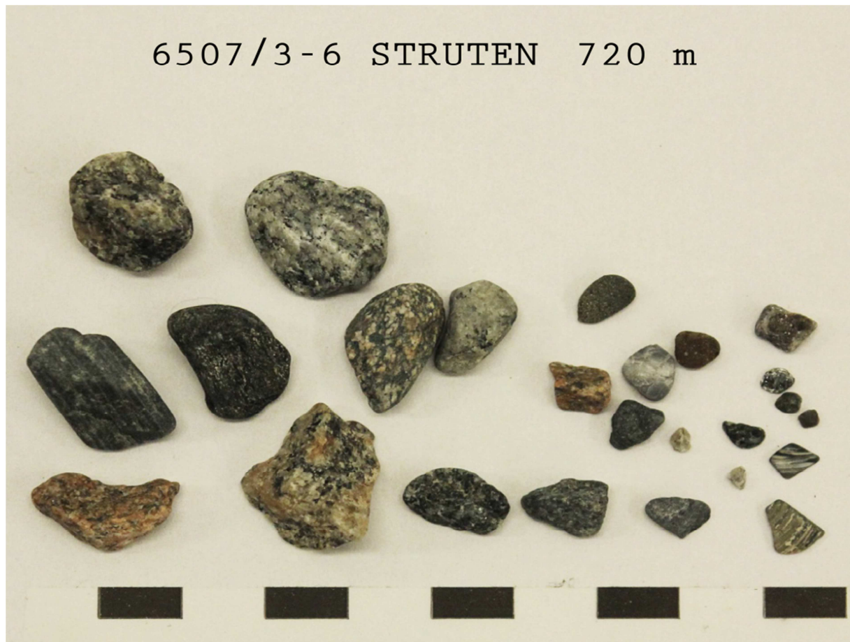
Figur 43: Beskrivelse av grusfraksjon for prøve 6507/3-6 Struten, 720 m. Grusfraksjonen i denne prøven utgjør 20,4 g, tilsvarende 2,5 % av total prøvemengde. Denne prøven består i stor grad av krystalline bergartsfragmenter og oppknuste skjellfragmenter.
