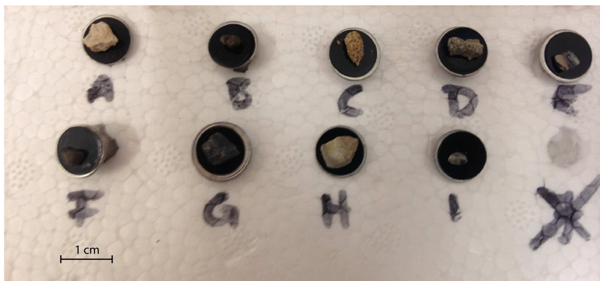
Figur 53: Bilde av klaster som skal undersøkes med sveipelektronmikroskop, analyse 2. Klastene er plasserte på dobbeltsidig karbonteip, på hver sin aluminiumsknapp. Disse knappene plasseres ved undersøkelsen på en rund prøveplattform som elektronmikroskopet er programmert til å orientere seg etter. Gullpaladium (AuPd) skal også dampes på prøvene før undersøkelse. Seks av disse klastene er fra ulike dyp i brønn 6507/11-10 Frusalen (A, D, E, F, G, H), to av klastene er fra brønn 6507/3-6 Struten (B, C) og en klast (I) er fra brønn 6609/10-2 Trolla. Full oversikt over alle klaster og deres respektive dyp er gitt i vedlegg 4, tabell 2.
