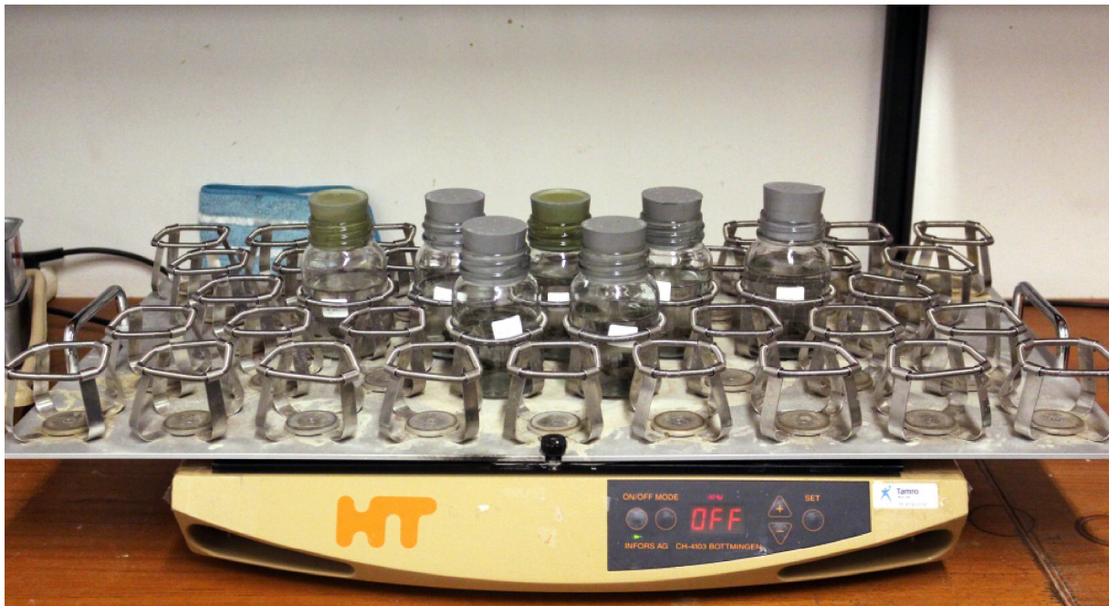
Figur 20: Ristebord brukt ved slemming av sedimentprøver. Ristebordet består av en sokkel med roterende bord og flaskeklemmer til prøveglass. Glassflasker med gummipropp festes i holderne, og metallbordet roterer mot klokken i en forhåndsinnstilt hastighet, i dette tilfellet 160 rpm ( rotations per minute ).
