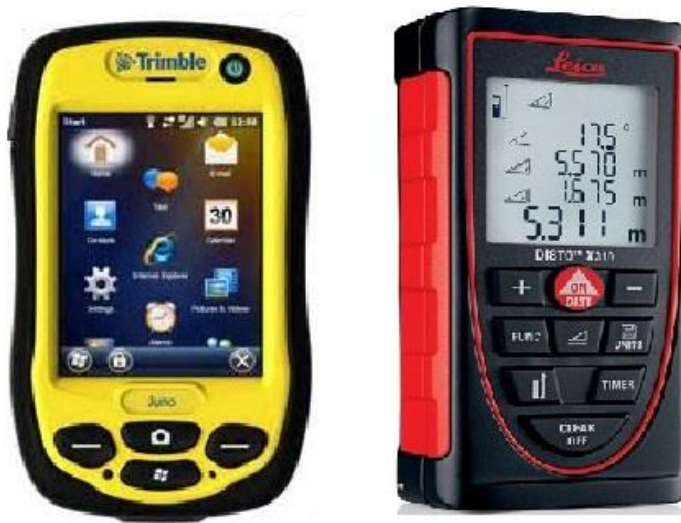
Figur 3.1: Viser de to instrumentene Trimble Juno (til venstre) og DistoX 310 (til høyre) som ble brukt under kartleggingen av grottene.
