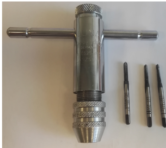
Figur 9: Gjengeverktøyet som ble brukt til å lage gjenger i aluminiumsprofilene.
