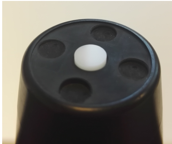
Figur 38: Irradianssensoren har en flat, spredende måleflate, noe som gjør at den måler den plane irradiansen over alle retninger i den øvre halvkule.
