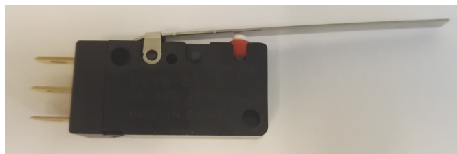
Figur 15: Referansebrytere av denne typen er brukt for å finne startposisjonen før målingene starter.
