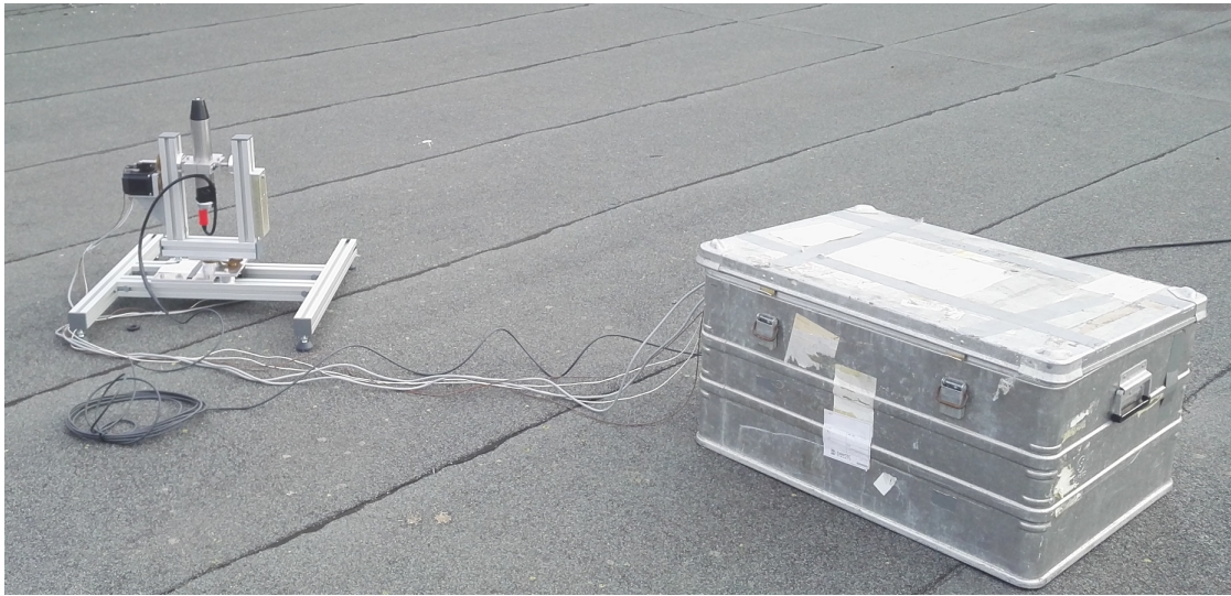
Figur 43: En aluminiumskasse ble brukt for å skjerme cRIO, PC-en og strømforsyningen fra regnet.
