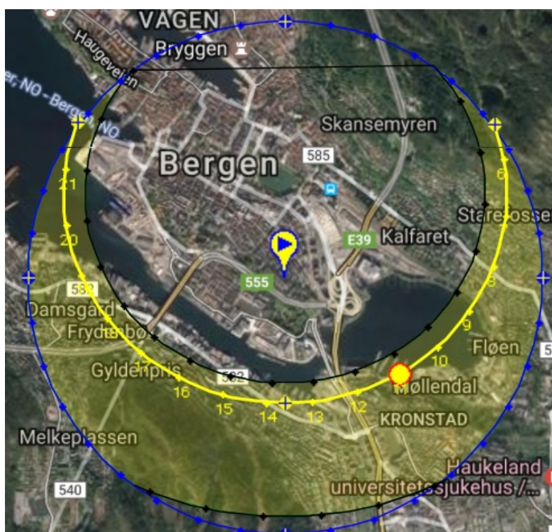
Figur 46: Den gule linjen viser solbanen 4. mai 2017, og tallene langs den angir klokkeslettene for når solen er i de forskjellige posisjonene. De svarte ringene viser solbanen på årets lengste og korteste dag. Når linjen for solbanen krysser den blå ringen, betyr det at solen er gått ned. Nord er opp på figuren [17].
