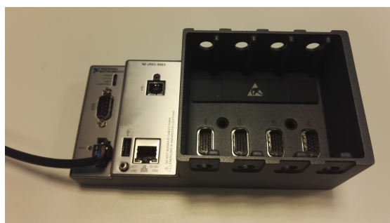
Figur 11: cRIO-9063, benyttet i prosjektet.
