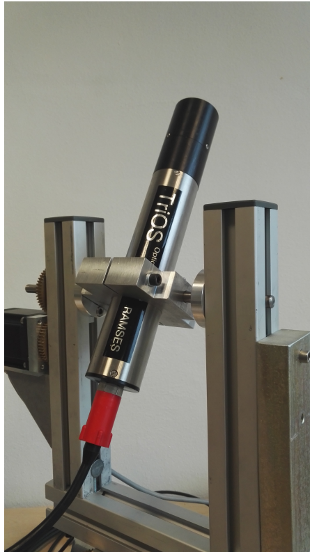
Figur 35: Ramses radianssensoren montert i goniometeret.
