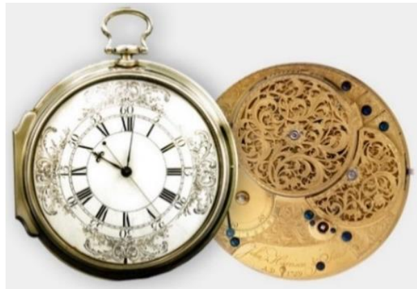
Figur 8: Harrisons marine kronometer H4 fra 1761 (Sobel og Andrewes 2006).
