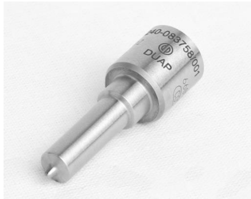
Figur 43 - Bosch dyse, DLLA. Bildet viser en av de ferdigproduserte dysene med borerer utført av DUAP. Foto: Daniel Gjelsvik
