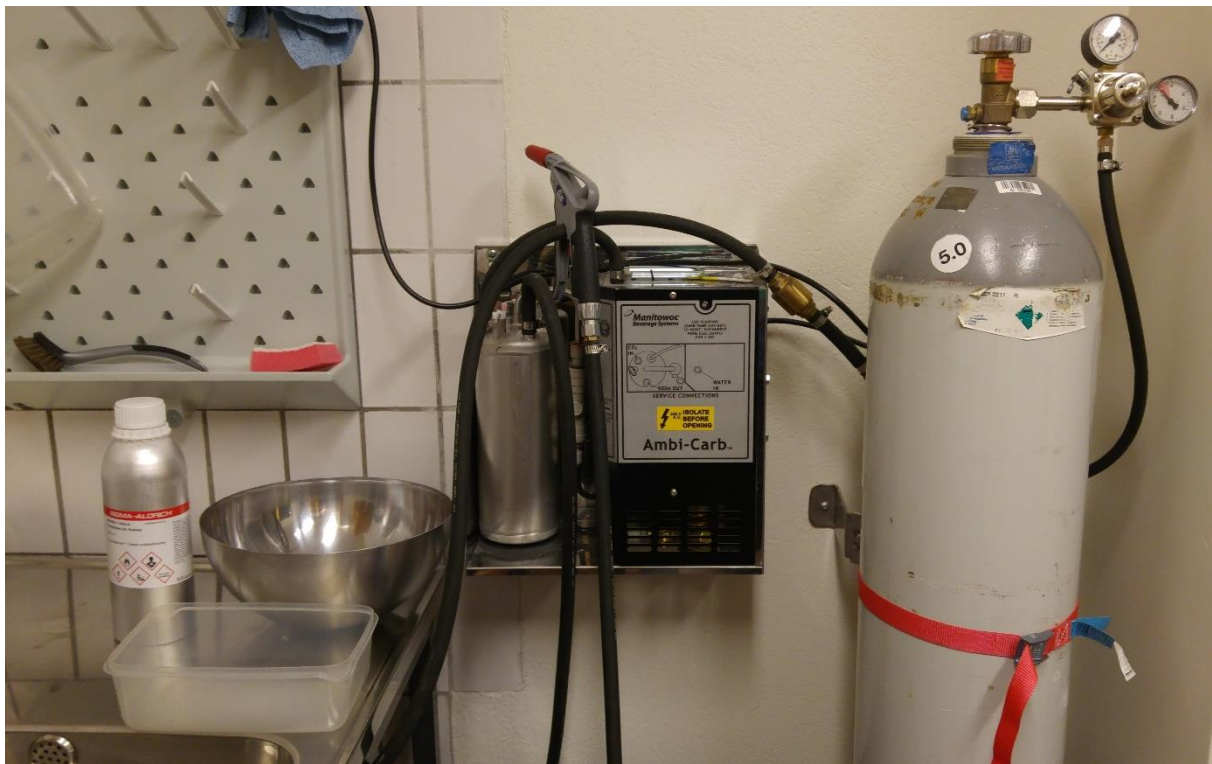
Figur 3.7: Nødvendig utstyr for stålbolle-flotasjon. Fra høyre: CO 2 -tank, karbonator med tilsetter, stålbolle for flotasjon, plastboks for F-fraksjon og Sigma-Aldrich eukalyptusolje Foto: Håvard Grønnevik.
