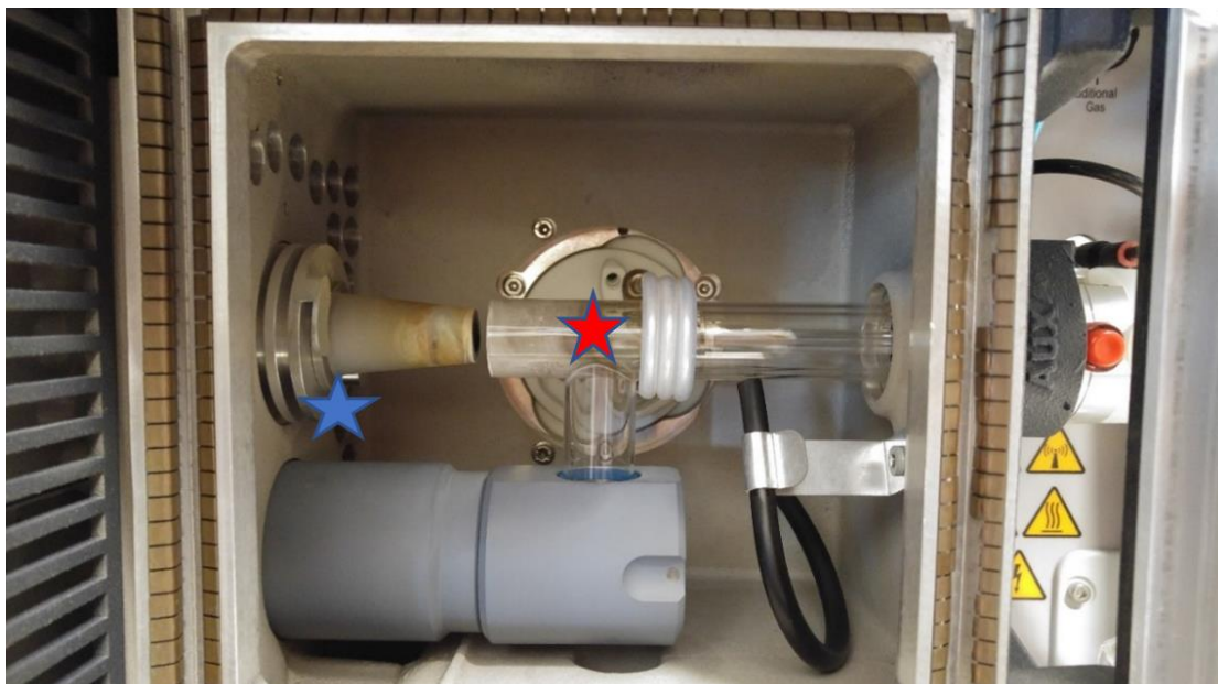
Figur 3.11: «Kammeret» der prøven varmes opp i et plasma som drives av en RF (radio-frekvens)-generator. Blå stjerne= aksial avlesning, rød stjerne= radial avlesning. Foto: Håvard Grønnevik
