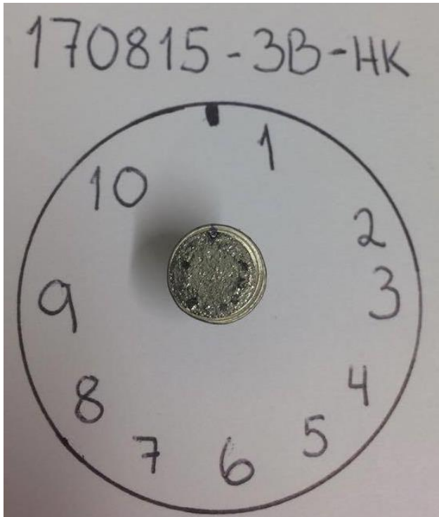
Figur 3. 3. Bilde av de ti kvartskornene som ligger på metallstubben fra prøve 170815-3B-HK.
