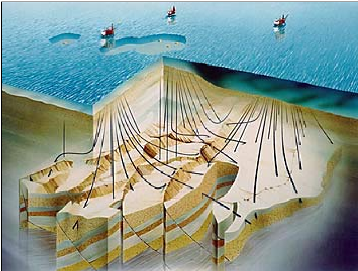
Figur 1.2. Gullfaksfeltet drives fra tre produksjonsplattformer, Gullfaks A, B og C. Satellittfeltene blir fjernoperert fra Gullfaks A og C ved hjelp av havbunnsinstallasjoner. Figuren er hentet fra Statoils hjemmesider.
