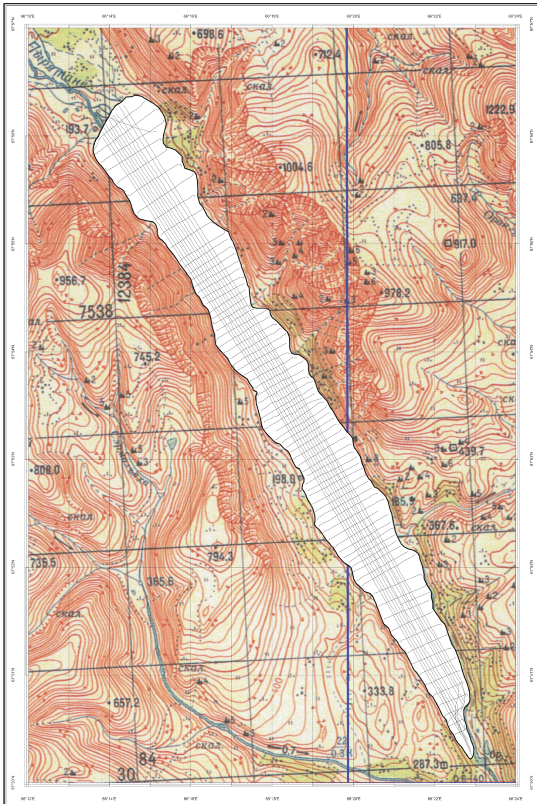
Figur 3.1: Kart med oversikt over innsamlet sparker-profiler. Sparker-datasettet består av totalt 91 seismiske profiler hvorav 12 er lengdeprofiler og 79 er tverrprofiler.
