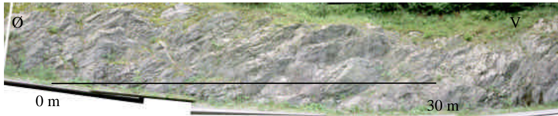
Figur 6.24. Bruddfrekvensprofilen fra Dolvik. Profilet er Ø-V orientert. Bildet er tatt mot S. Lengden på blotningen er vist på bilde, cirka 30 meter (Foto: Ole Nesse).
