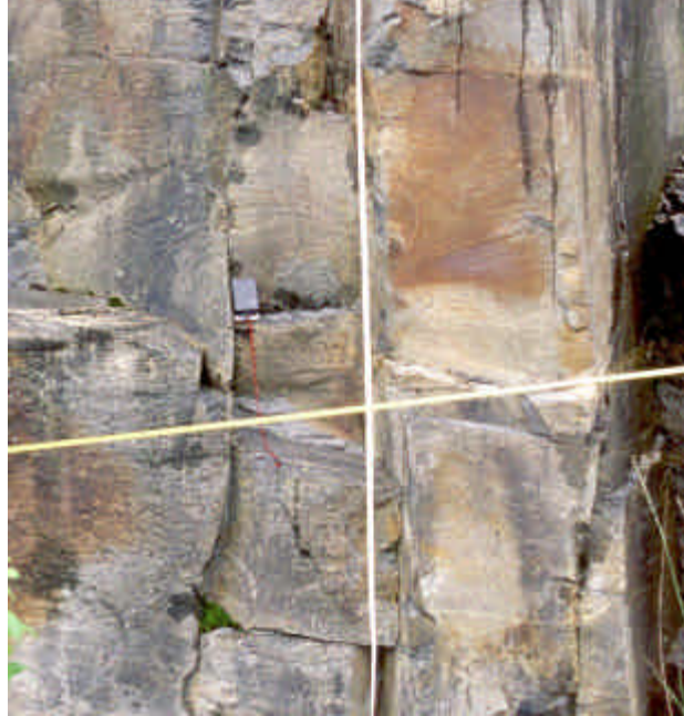
Figur 2.3. Traversmetoden med horisontalt og vertikalt profil. Bildet er tatt mot NV. Kompass til skala.
