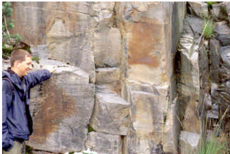
Figur 6.3. Et utsnitt av lokalitet Sandeidet. De tre bruddsettene, hvor steile, N-S trendene brudd dominerer. Bilde tatt mot nordvest. Person som skala (Foto: Ole Nesse).
