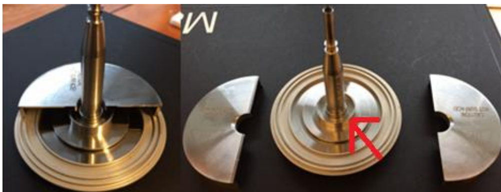
Figur 4.3.3 Lokk med silikonfelle. Silikon legges i ringen som er tredd på spindelen merket med rød pil
