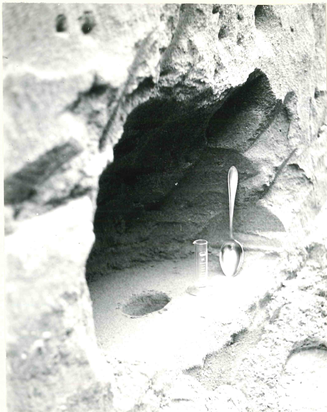
Fig. 64 : Ved hjelp av dette enkle utstyr ble sandens poretall målt.
