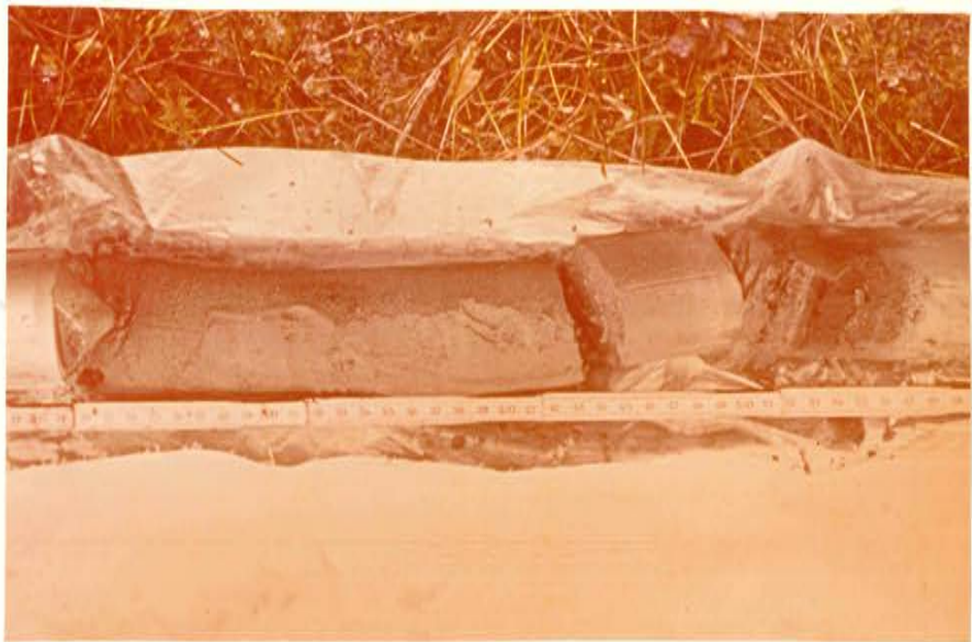
Fig. 102. De nederste 40 cm av borekjerne fra Tverramyra, bunnen til høyre på bildet. Legg merke til gytjelaget ca. 5-6 cm over bunnen av kjernen. Over ligger det godt sortert sand.
